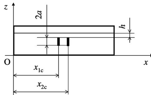
(b) Crack parameters
