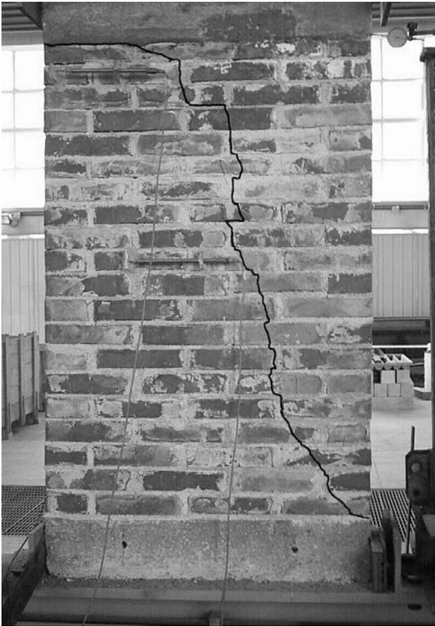
Figure 8 : Crack pattern
