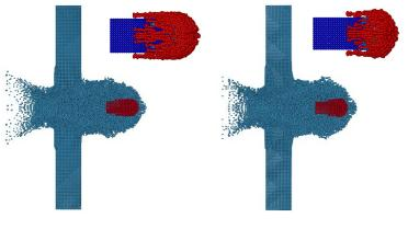
(c) (d) **Figure 11:** Deformations of projectile and target at 60  $\mu$ s obtained by SPH with PAM: (a)  $Q_2=0.4$ ; (b)  $Q_2=0.8$ ; (c)  $Q_2=1.2$ ; (d)  $Q_2=1.6$
