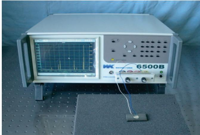
Figure 2: WK 6500B precision impedance analyzer
