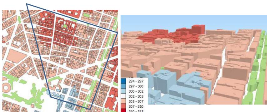
Figure 16. Représentation 2D et 3D des températures à l'intérieur des bâtiments sur les objets support 'bâtiment'. Données BDTopo et Températures calculées en °K par SURFEX-TEB
